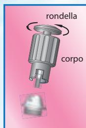
Facendo combaciare il corpo con le scanalature laterali del cono filettato avvitare la rondella del driver sulla testa filettata
